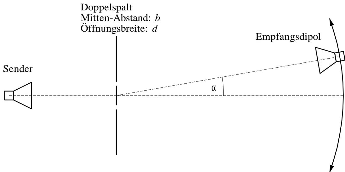
Ein Mikrowellen-Sender strahlt gleichmäßig einen Doppelspalt aus. In hinreichend großer Entfernung wird hinter dem Doppelspalt ein Empfangsdipol angebracht, welcher entlang des eingezeichneten Bogens bewegt werden kann. Für  $\alpha = 0$  registriert man einen maximalen Empfang. Vergrößert man  $\alpha$ , so registriert man abwechselnd minimalen und maximalen Empfang.
