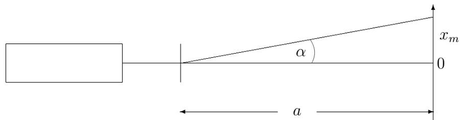
Trigonometrische Betrachtung des Strahlengangs bis zum Schirm liefert mit der Kleinwinkelnäherung:
