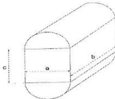
Ein Heizöltank besteht aus einem quaderförmigen Mittelteil und zwei halben Kreiszylindern (siehe Skizze). Die Maße sind:  $a = 1\text{m}$ ,  $b = 2\text{m}$  und  $c = 1\text{m}$ .
