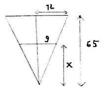
Mit Hilfe des 2. Strahlensatzes kann die Höhe x ermittelt werden, mit der der Verschluss in der Flasche steckt:
